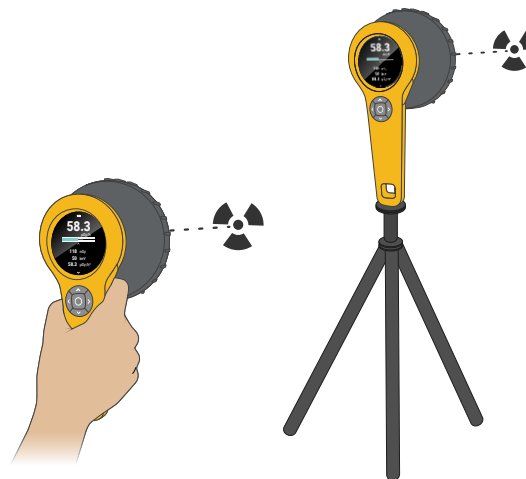
Figura 3. Posicione com a área do sensor voltada para a fonte de radiação.
