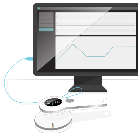
Figura 10. Conecte el instrumento a RaySafe View.
