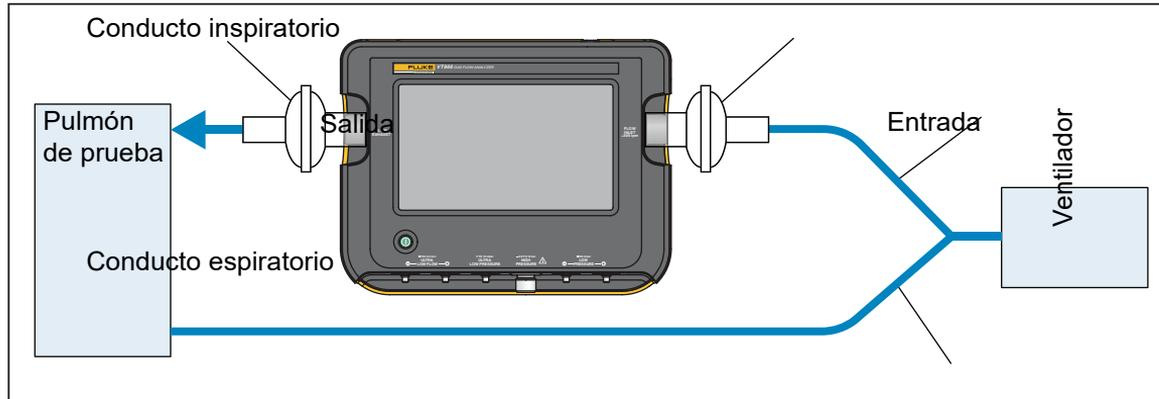
**Figura 3. Conexiones del circuito de respiración espiratorio**
