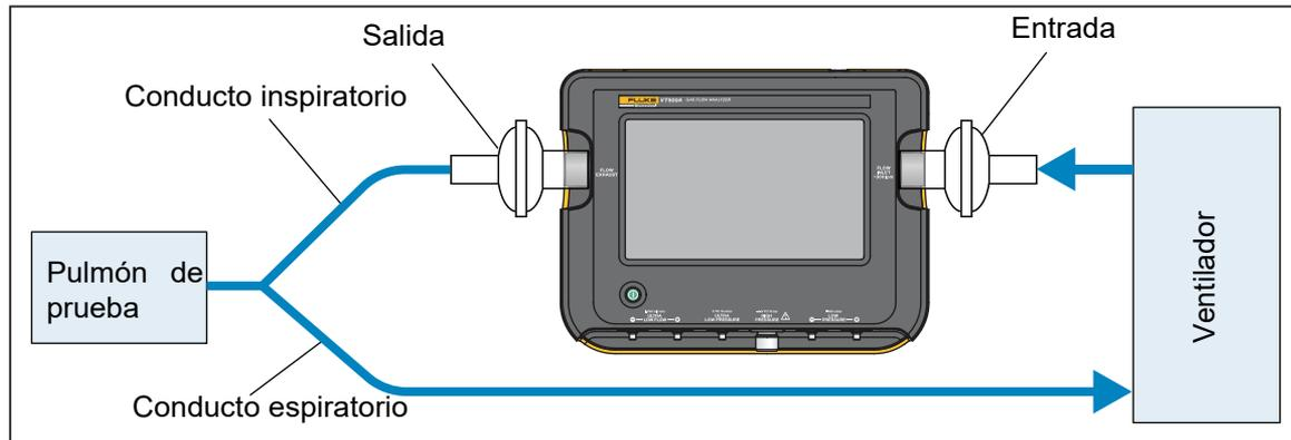
**Figura 2. Conexiones del circuito de respiración inspiratorio**
