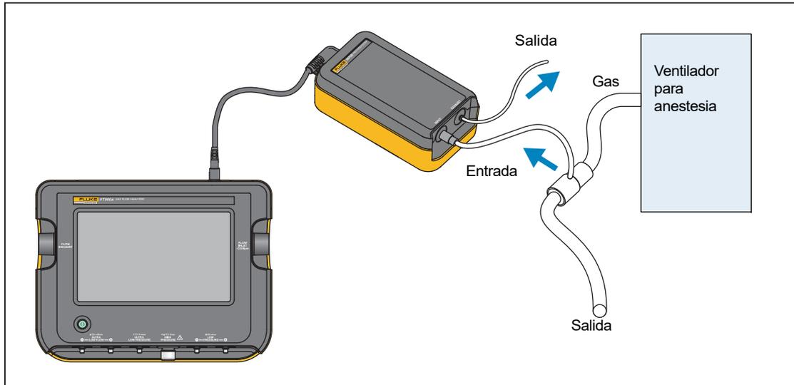
**Figura 4. Conexiones de gas para anestesia**
