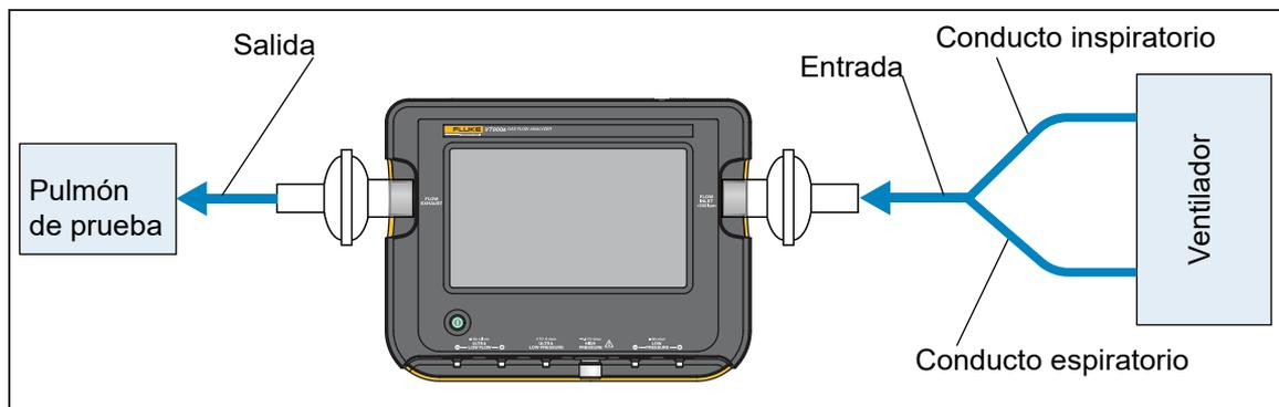
**Figura 1. Conexiones del modo de flujo bidireccional**
