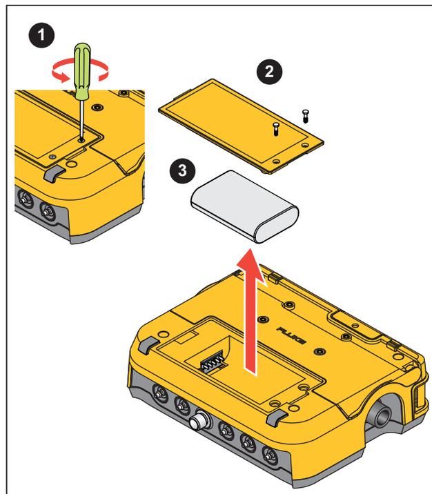
Figure 5. Reemplazo de las pilas
