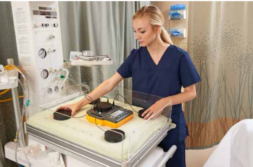
Los discos son utilizados con el analizador de incubadoras/calentadores radiantes INCU II para verificar el rendimiento de un calentador radiante
