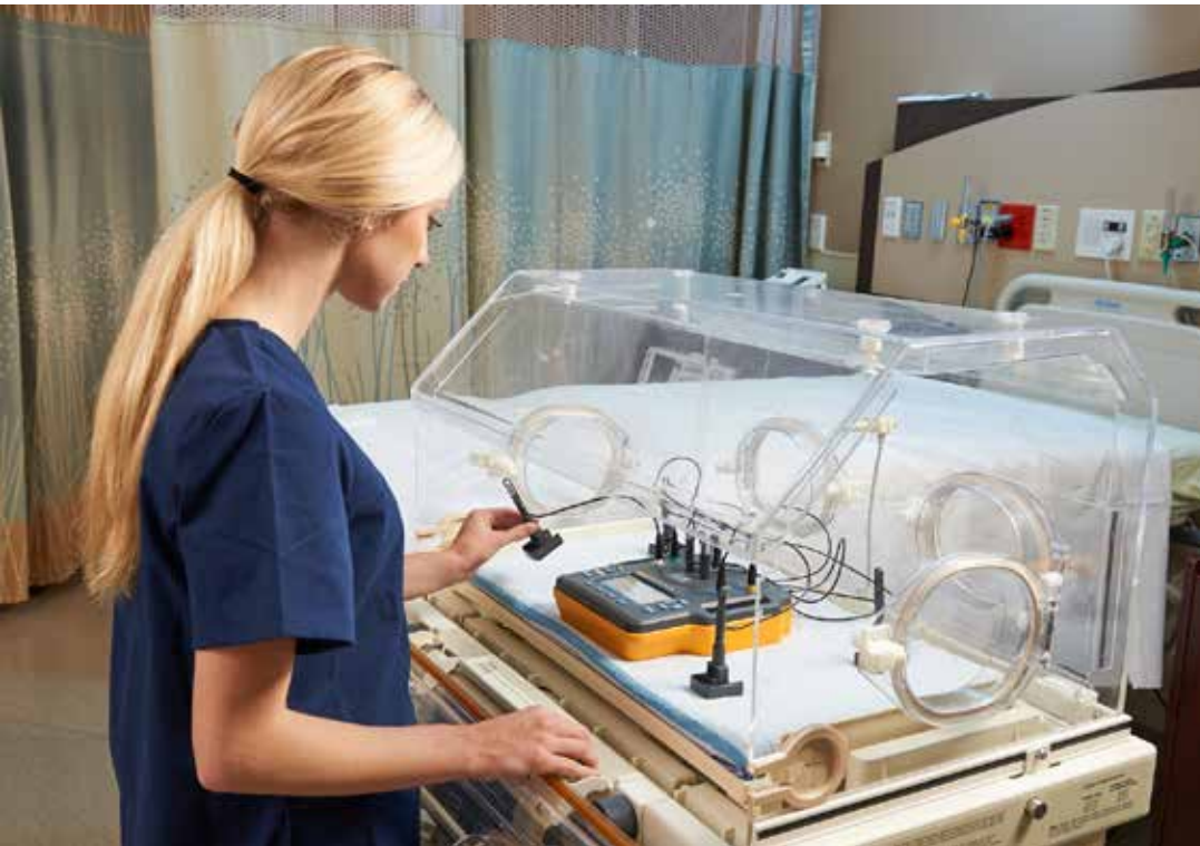
El analizador de incubadoras/calentadores radiantes INCU II está siendo utilizado para realizar pruebas en una incubadora para bebés
